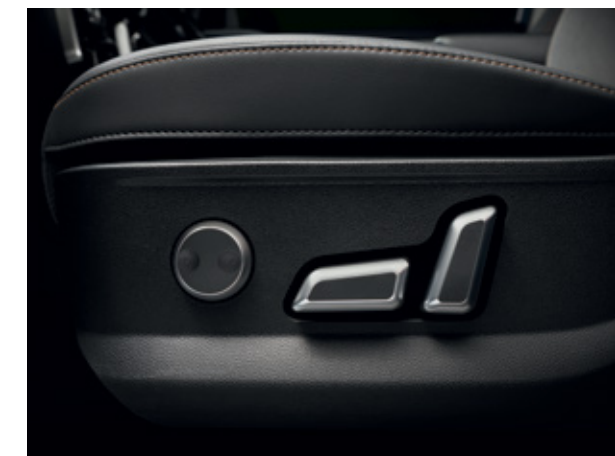
Электрорегулировка сиденья водителя в 8 направлениях
