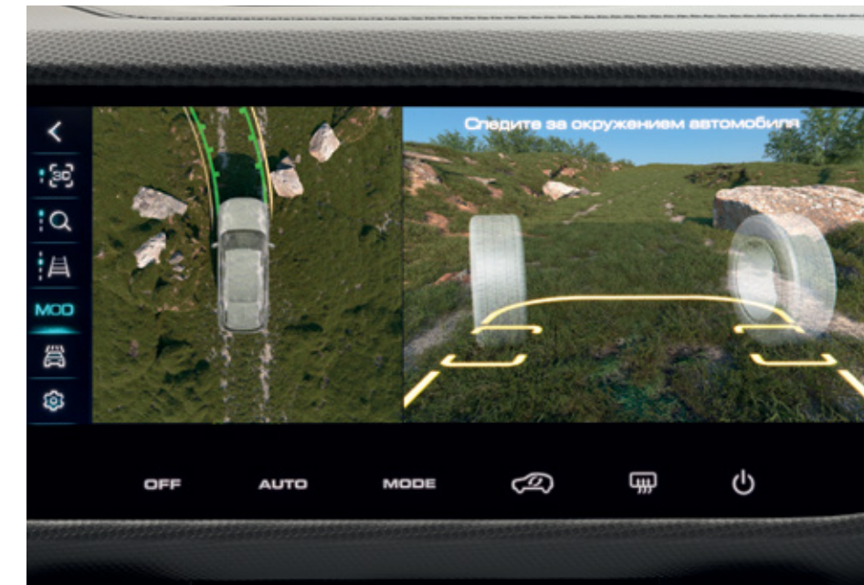
Функция также показывает угол поворота передних колес
