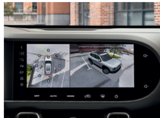
Система камер кругового обзора 360°
