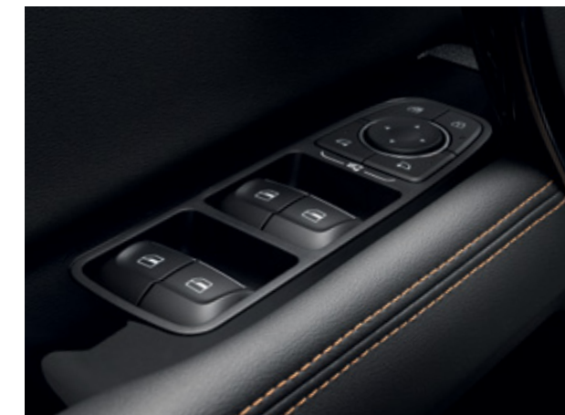
Электростеклоподъемники с автодоводчиком четырех дверей и функцией защиты от защемления
