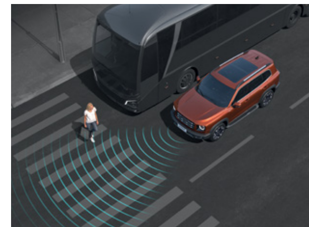
Автоматическая система торможения с функцией распознавания пешеходов
